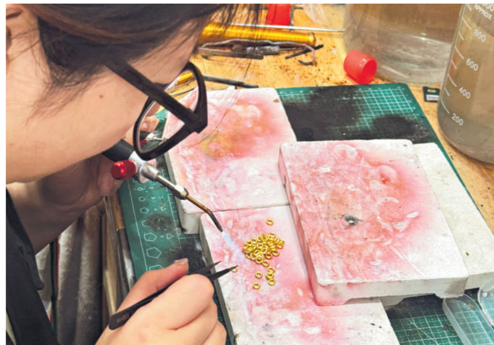
马羽彤拿着火枪对着用旧金做的盘缠进行原金焊接。王凤仪 摄
